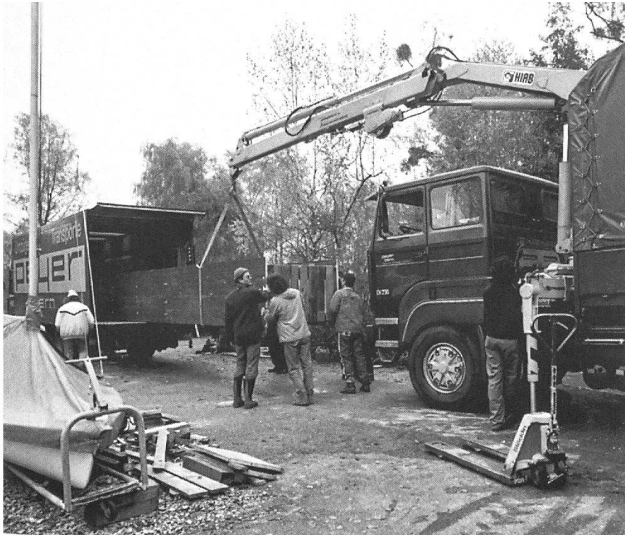
Abb. 15: Erlach - Heidenweg 1992. Wiederausgraben und Verladen des Einbaumes im Herbst 1993. Die mit einer weiteren Versteifung versehene Holzkiste wird mittels Hebebühne und Kran in den 8 m langen Transporter verladen.
