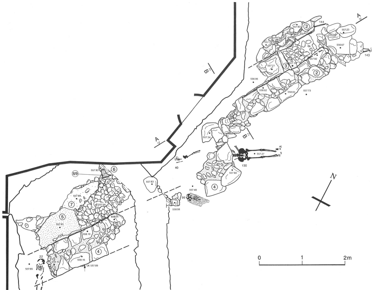
Abb. 6: Ausschnitt der Befunde zu Grabkammer und Westanbau. Grundriss M.1:50. 2 Seitenmauern, 3 gestellte Platte (Zwischenwand), 4 Schulter und Südmauer Westanbau (Memoria?), 5 Mörtelgussboden auf Kieselrollierung, 6 Schrankenpostennegativ (?), 7 grosse Flickstelle in Mörtelguss, 8 kleine Flickstelle zu (6), 9 Flickmörtel.
