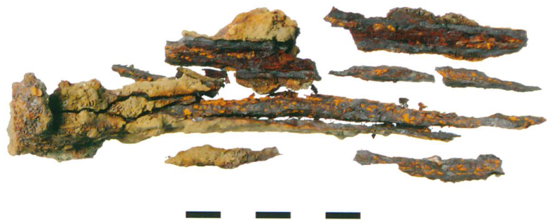
Fig. 1 : Bern, Gerechtigkeitsgasse/Kramgasse 2004, clou non traité, détérioré par la corrosion active.
