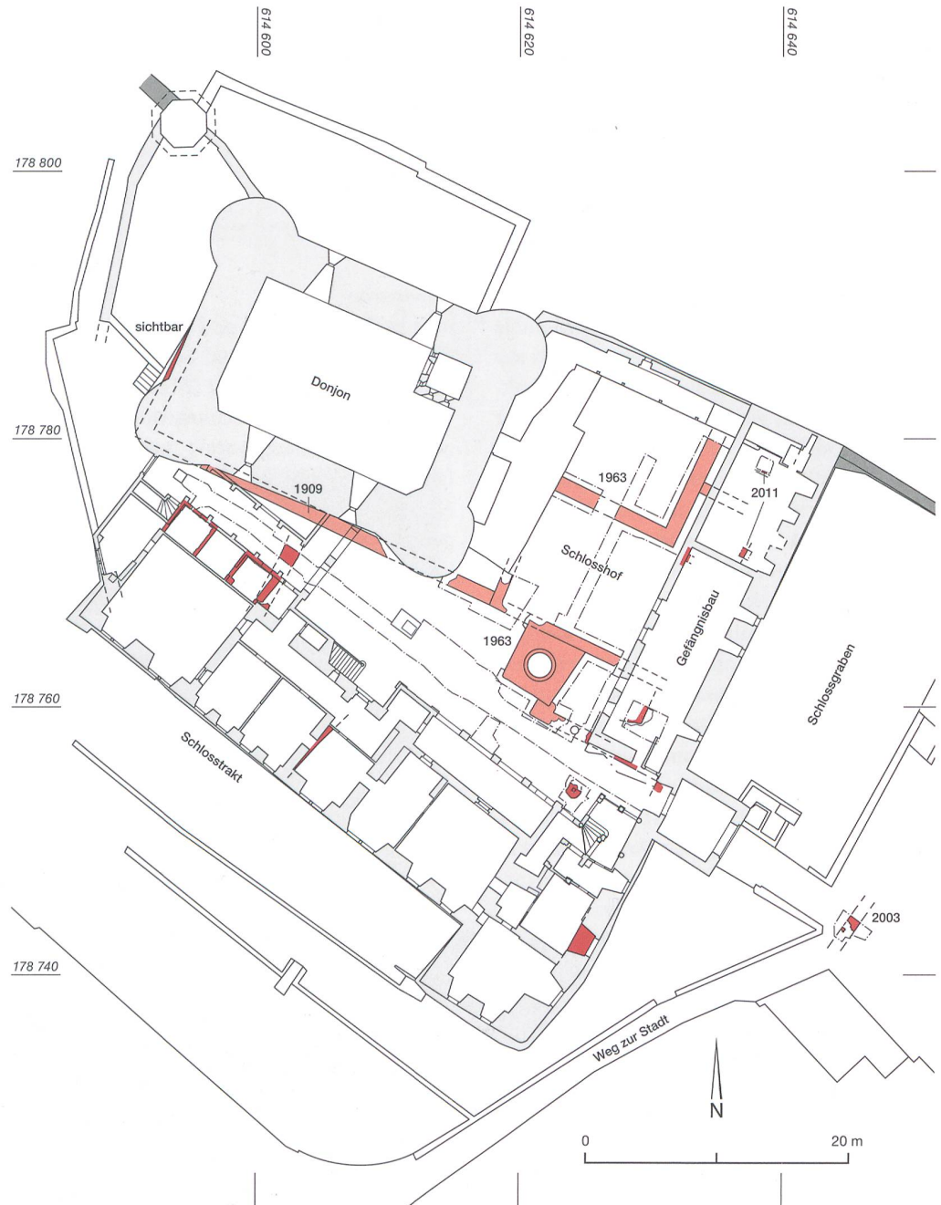
Abb. 2: Thun, Schloss. Übersichts- und Phasenplan zum Baubestand von Schloss Thun mit Eintrag der aktuellen Ergebnisse und den Resultaten der Altgrabungen von 1909 und 1963. M. 1:500.
