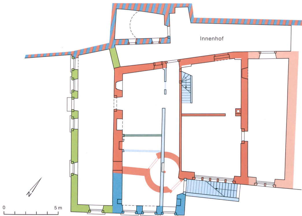
Abb. 2: Ligerz, Chlyne Twann 7. Grundriss des ersten Obergeschosses. Mit dem satten Rot ist der mögliche Kernbau, mit dem hellen Rot die östliche Hausparzelle gekennzeichnet. Ab der zweiten Hälfte des 16. Jahrhunderts zählten diese Teile zur gleichen Liegenschaft. Die südseitige Erweiterung des Saales (dunkelblau), die Unterteilung der Innenräume (hellblau) und die westseitige Erweiterung (grün) sind jüngere Veränderungen. Rot-blau schraffiert sind die Hangstützmauer und der rückwärtige Keller, die beide wohl zum Ursprungsbau zählen, aber auch erst in Phase Blau angelegt worden sein könnten. M. 1:200.
