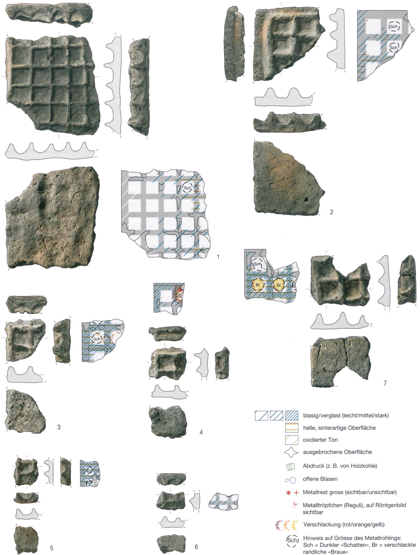
Abb. 1: Roggwil, Ahornweg 1. Tüpfelplattenfragmente, Auswahl. Fotos, Querschnitte und schematische Zeichnungen des Spurenbildes. M. 1:2.
