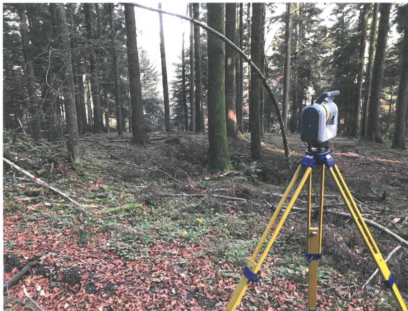
Abb 7: Trachselwald, Chammenegg. Vermessung des Geländes mithilfe der Totalstation und des Laserscanners mit Unterstützung des Globalen Navigationssatellitensystems (GNSS).
