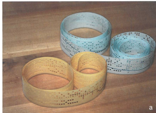
Abb. 7: Für die ersten dendrochronologischen Untersuchungen der Hölzer von Twann wurden die Messungen der Jahrringbreiten der Hölzer auf Lochstreifen (7a) erfasst, auf Lochkarten (7b) übertragen und von einem Techniker in den Hauptcomputer der Universität Köln eingespielen.
