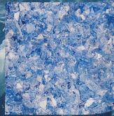
Aus alten Plastikflaschen wird neues Plastikgranulat
