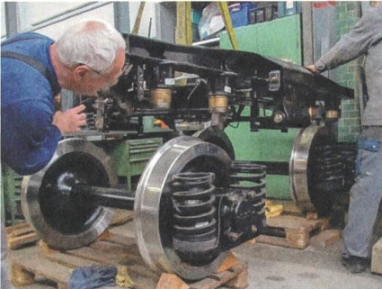
↑ Aufbau des total revidierten Drehgestells in der Werkstatt Aarau. (Foto: Beat Unterweger)
