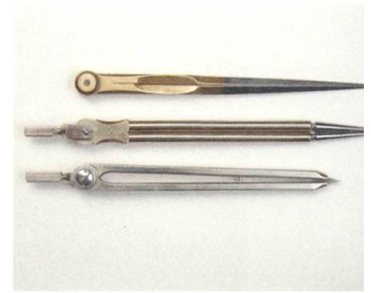
↑ Entwicklung der Zirkelform: «Aarauer Form» (19. Jahrhundert, oben), Rundform (1904, Mitte), Flachrundsysteem (1913, unten). (Stadtmuseum Aarau, Foto: Markus Meier)
