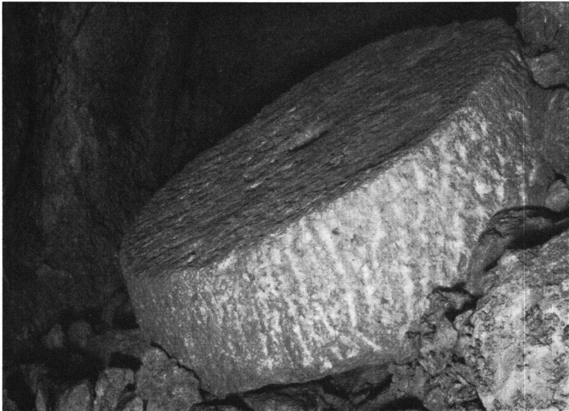
Abb. 5. Grobkalk von Chalofen bei Villnachern. Abbauhöhle mit teilweise ausgehauenen Mühlsteinen. Photo: HANS FEHLMANN, Zürich/Villnachern
