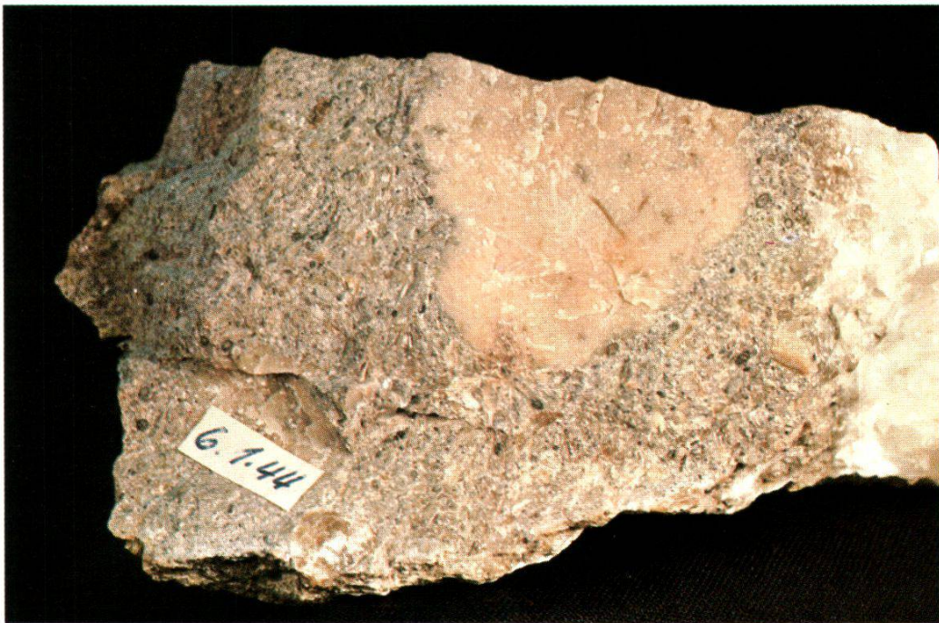
Fstk. 6.1.44; Fo. 3.2.2.2, Oberegg Auenstein; feinkristalliner Calcit , hellbraun, Knolle in Oolith; Hauptrogen- stein; Vg. 1,0 ×
