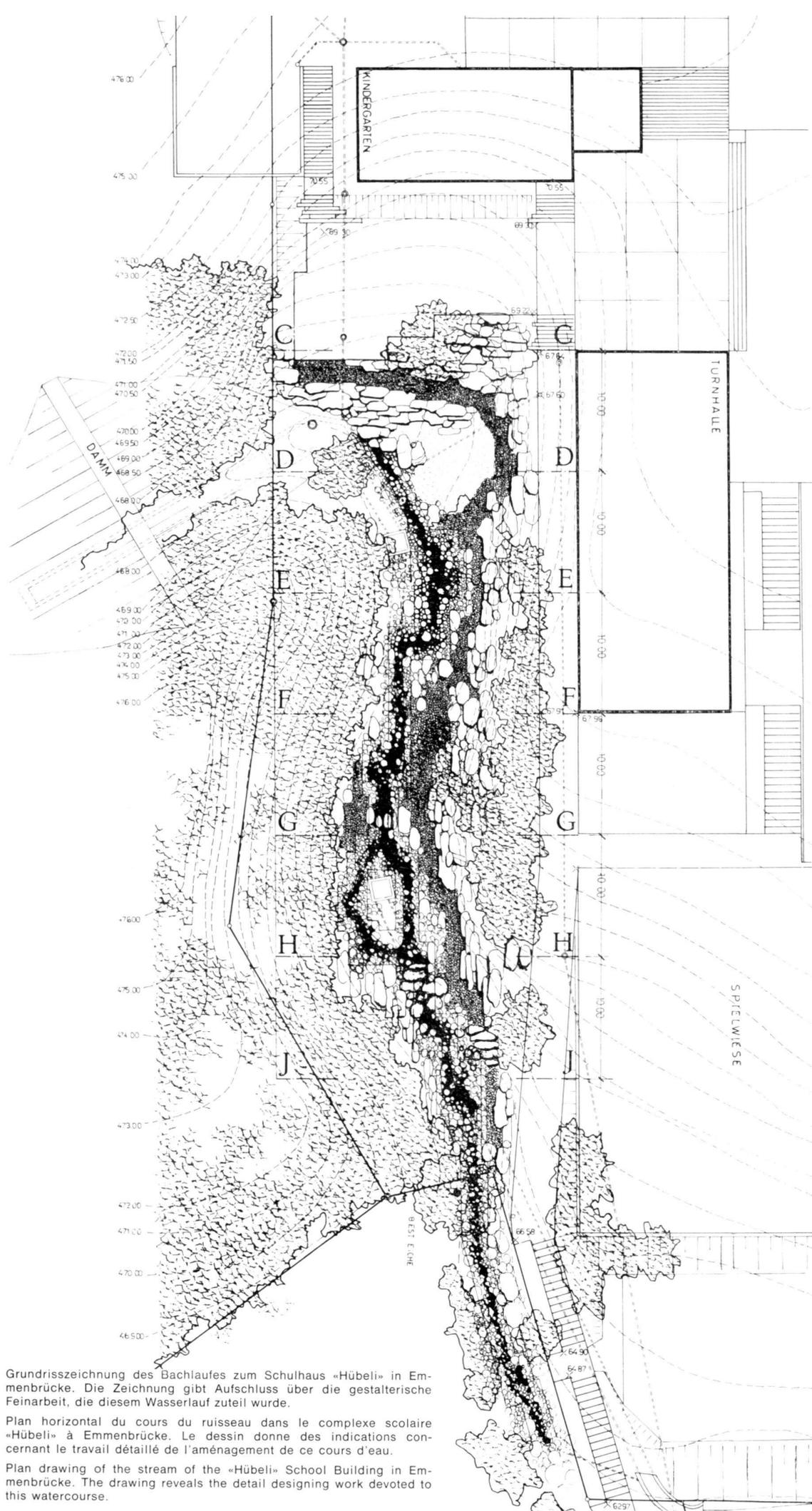
Grundrisszeichnung des Bachlaufes zum Schulhaus «Hübeli» in Emmenbrücke. Die Zeichnung gibt Aufschluss über die gestalterische Feinarbeit, die diesem Wasserlauf zuteil wurde.
