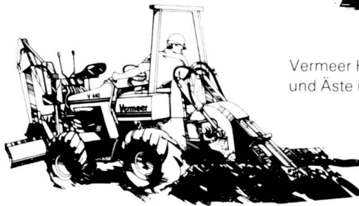
Grabenfräsen auf Pneu und Raupen für Grabtiefen bis 360 cm, Grabbreiten von 7–90 cm
