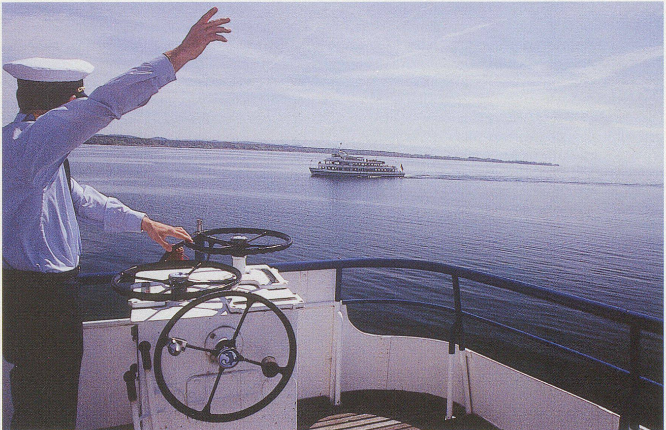
Vier «Nocks» (Steuersockel) an Bug und Heck, jeweils Backbord und Steuerbord, ermöglichen es dem Kapitän, die Motorfähre auch ausserhalb des Steuerhauses unter Kontrolle zu behalten.
