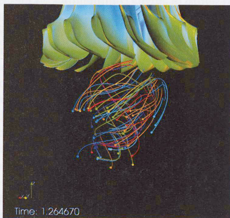
Fig. 5 – Evoluzione del sistema vorticoso per un'ala a delta a numero di Mach elevato
