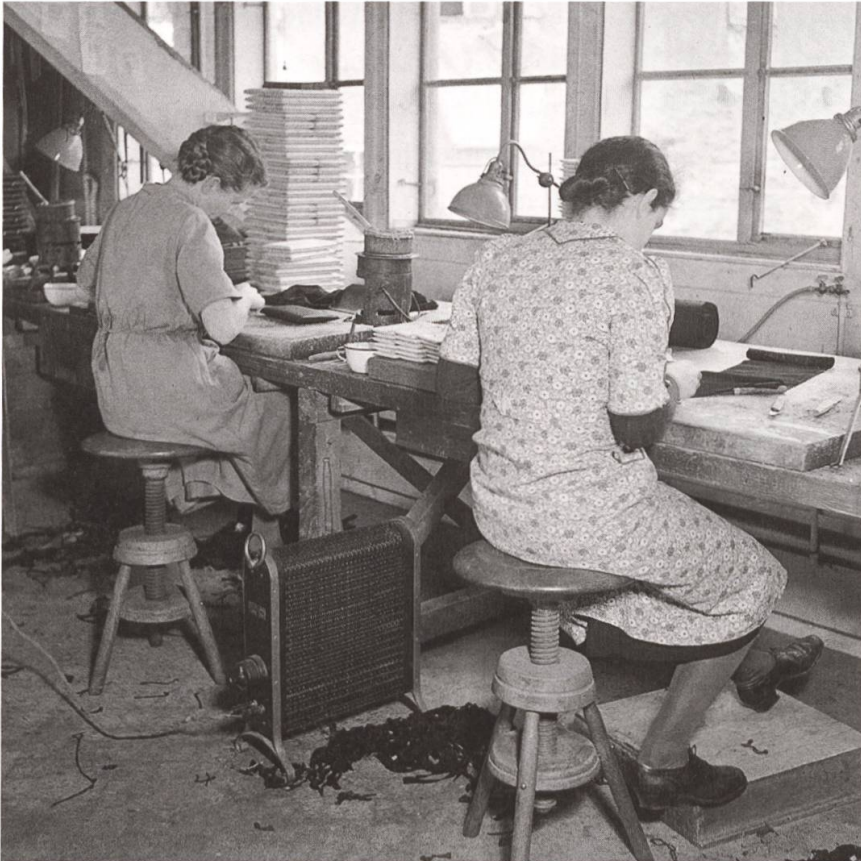
4 Arbeiterinnen stellen Zirkeletuis her, um 1940. Die mit Samt ausgeschlagenen Etais dienen nicht nur zum sicheren Transport der filigranen Instrumente, sondern unterstrichen auch deren Wert (Bild: Stadtmuseum Aarau, Ringier Bildarchiv).
