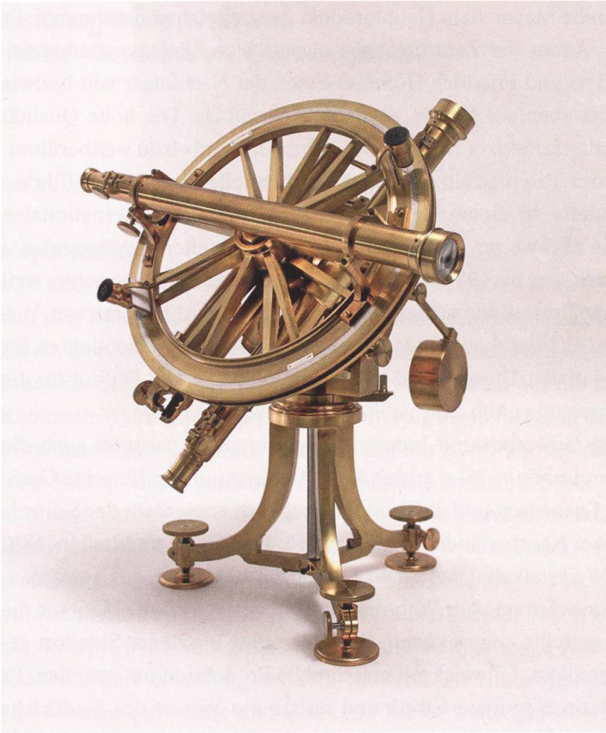
1 Bordakreis zur Messung von Horizontal- und Vertikalwinkel. 1835 von Kern für die Triangulation zur Dufourkarte angefertigt (Foto: Stadtmuseum Aarau, Sammlung Kern).
