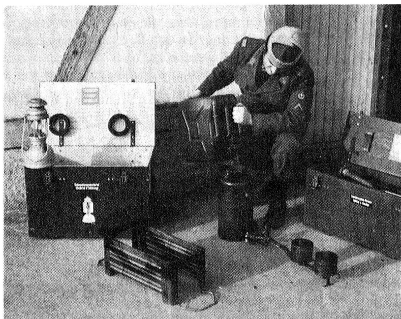
Der Küchenchef füllt den Benzinvergaserbrenner mit Betriebsstoff, Benzin bleifrei!
