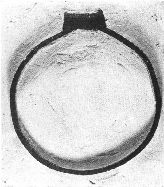
Abb. 84. Augst. Bleirohr, Querschnitt.
