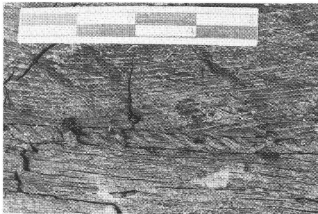
fig. 11a Calfatage par une cordelette fixée par des clous. Photo Y. André. Kalfaterung mittels einer mit Nägeln befestigten Schnur. Calfataggio con una corda fissata con chiodi.
