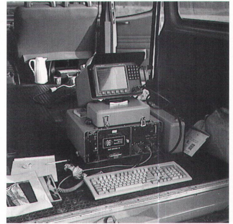
Abb. 15 Die Radaranlage besteht im wesentlichen aus einem feldtauglichen Computer mit einer speziellen Karte und eingetragener Software. Un ordinateur capable d'opérer sur le terrain à l'aide d'un programme et d'une carte spécialement conçus sont les éléments centraux de l'installation radar. L'impianto radar è costituito essenzialmente da un computer da campo con una carta speciale e software integrato.
