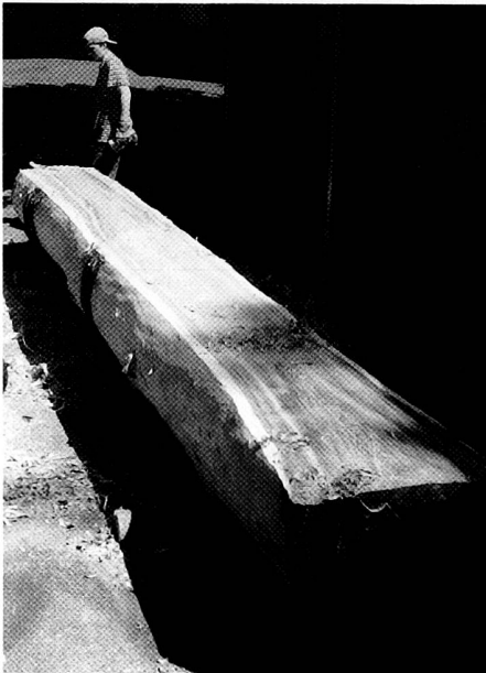
Abb. 4 Der Pappelstamm mit bereits abgeflachtem Bootsboden. Deutlich sichtbar sind der helle Splint und der dunkle Kern des Holzes. Le tronc de peuplier; le fond est déjà façonné. On notera la présence de l'aubier, plus clair que le coeur du bois. Il tronco di pioppo con il fondo dell'imbarcazione già appiattito. Chiaramente visibili sono il libro chiaro e il centro scuro del legno.
