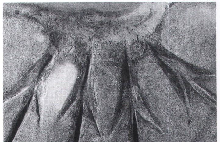
Abb. 8 Experimentelle Sandsteingussform einer Bronzesichel. Die Tonflickstelle am Eingusstrichter bröckelt nach mehreren Güssen langsam ab (Foto SLM, Sektion Archäologie). Moule expérimental en grès d'une faucille en bronze. La réparation en argile sur l'entonnoir de coulée se détache. Stampo sperimentale in pietra arenaria di un falchetto in bronzo. La riparazione in argilla applicata sull'imbuto di colata si stacca progressivamente dopo varie colate.
