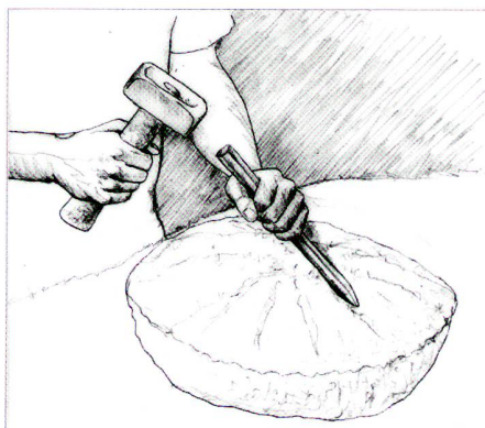
fig. 14 Etape de façonnage d'une meta. Dessin A. Pulido. Arbeitsschritt beim Zurichten eines Bodensteins. Una tappa della lavorazione di una meta.
