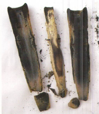
Abb. 5 Nach dem Guss aufgebrochene Form. Sichtbar ist die Schwarzfärbung des Tones im Innern der Form, die Kontaktstellen mit dem heissen Metall sind weisslich verfärbt. Die gegossene Spitze ist beinahe oxidfrei, nur der Mittelbereich, der beim Öffnen der Form noch heiss war, ist etwas angelaufen.
