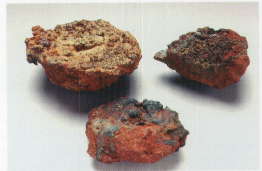
Scories coulées caractéristiques de la réduction du minerai de fer, provenant du bas fourneau, Chevenez-Lai Coiratte.
