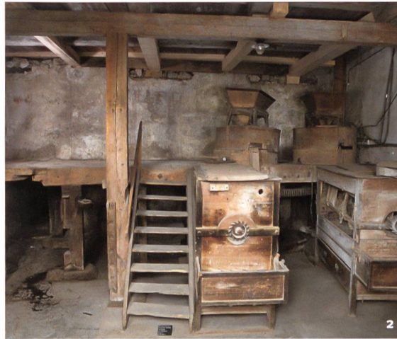
Fig. 2 Plateau de Diesse, Lamboing, Les Moulins 1. Machinerie du moulin à grain en fonction de la fin du 17 e au début du 20 e siècle.
