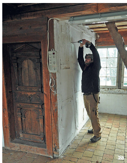
Abb. 2 Probenentnahme und dendrochronologische Auswertung im Labor.
