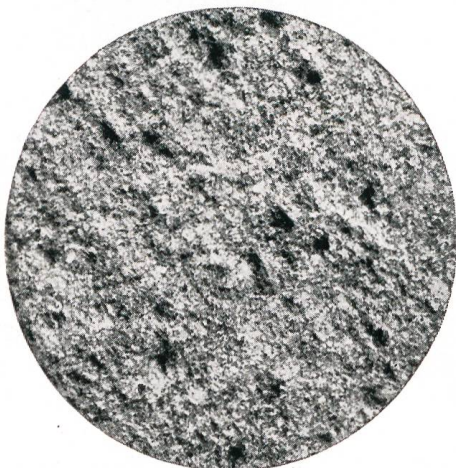
Mit dem Sandstrahlgebläse geprüfte Fläche von Guberstein Naturgrösse
