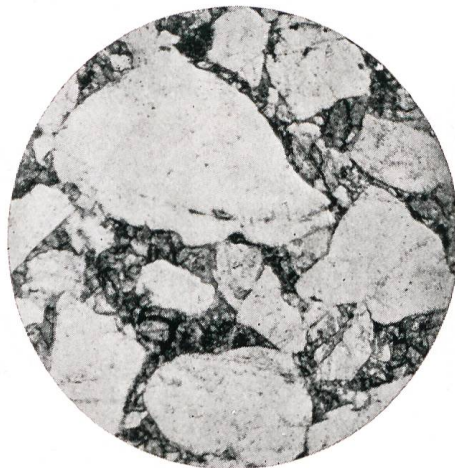
Dünnschliff von Guberstein (hell = Quarzkörner, dunkel = Kalkkitt) 32 mal vergrössert
