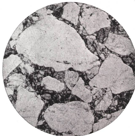
Dünnschliff von Guberstein (hell = Quarzkörner, dunkel = Kalkkitt) 32 mal vergrössert
