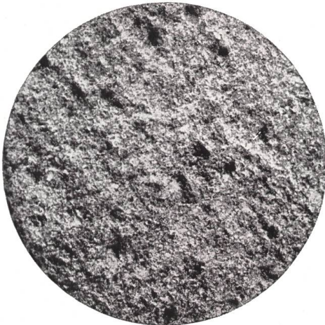
Mit dem Sandstrahlgebläse geprüfte Fläche von Guberstein Naturgrösse
