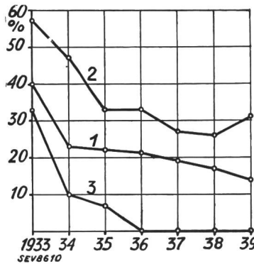
Fig. 4. Bei Nachprüfungen beanstandete Serien Schmelzeinsätze. 1 Mittel aller Fabrikate 2 Maximum eines einzelnen Fabrikats. 3 Minimum eines einzelnen Fabrikats.
