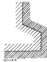
Fig. 2. Massif de fondation à base évasée Grâce à l'épanouissement de la base du massif qui pénètre dans la terre non remuée, la stabilité du massif est augmentée.
