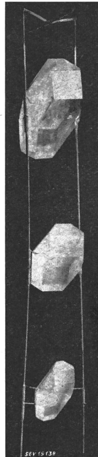
Fig. 3 Quarzkristalle, die in einem Autoklaven in 32 Tagen gezüchtet wurden Gewicht der Kristalle (von oben nach unten): 321, 143 und 71 g
