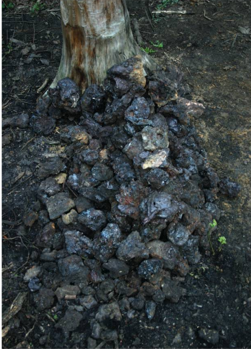
Fig. 9. Scories vitreuses noires (amas témoin laissé en place). Très friables, les morceaux de ce type ont une taille maximale de 15 cm.
