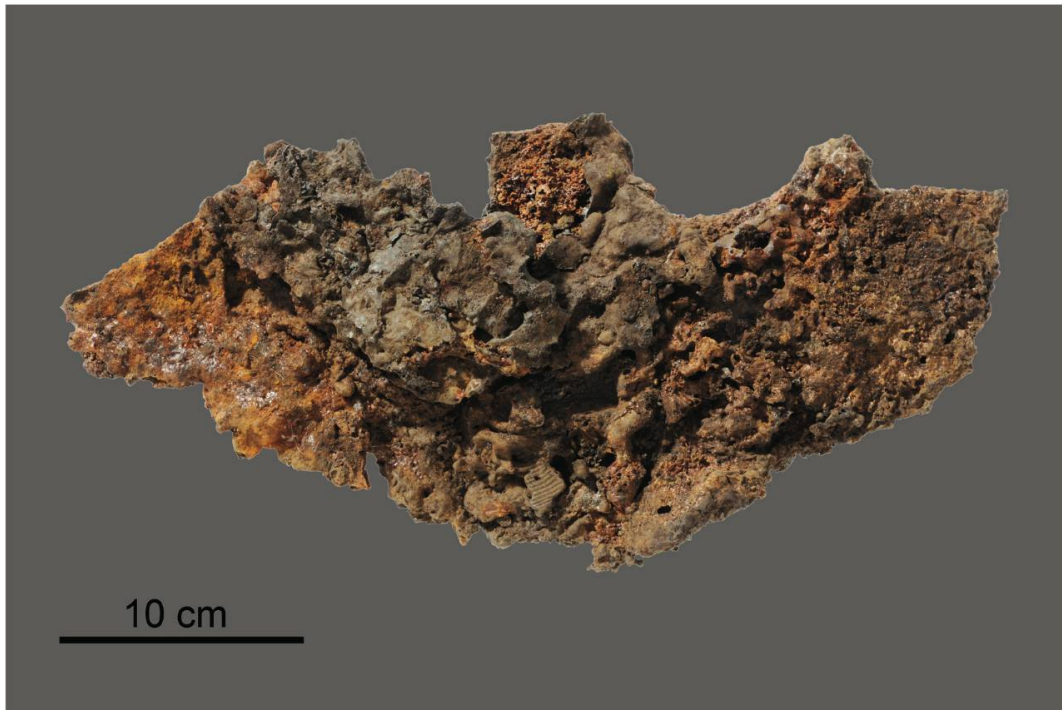
Fig. 4: Scories riches en fer N° 2 et 4 (cf. fig. 3). Vue de la face supérieure.
