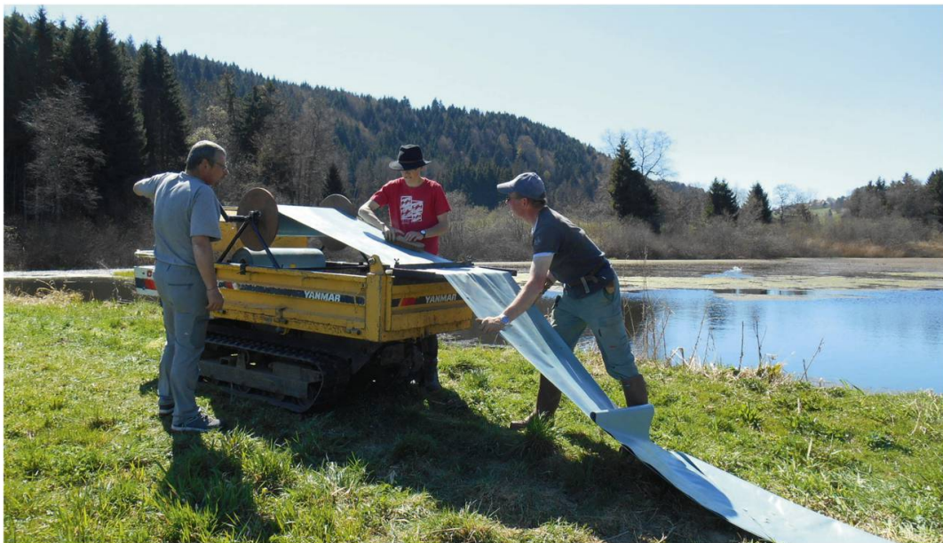
Fig. 5: Enrouleuse à bâches inventée et construite par M. Jean-Marie Gisiger. Photographie: Bertrand Saucy.
