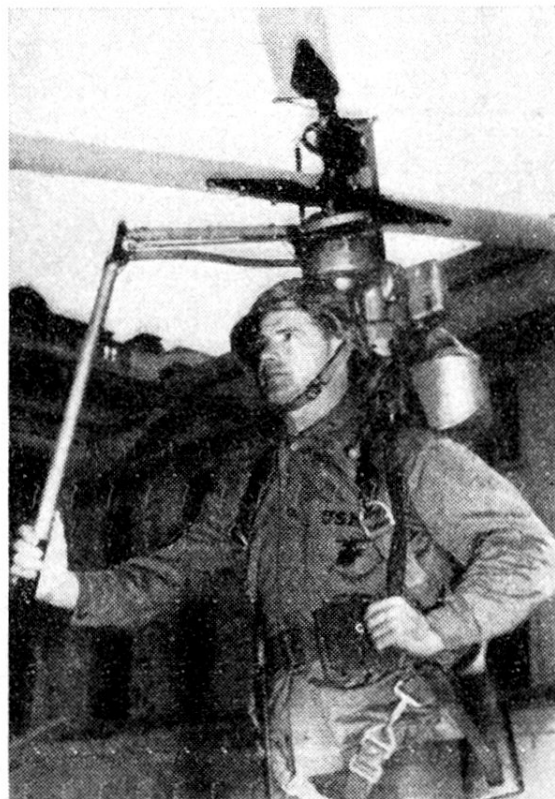
L'hopper: hélicoptère individuel de l'armée américaine. L'ingénieur allemand Weihrauch vient de construire un appareil semblable auquel un moteur de 14CV. donnerait une vitesse de 100 km/h
