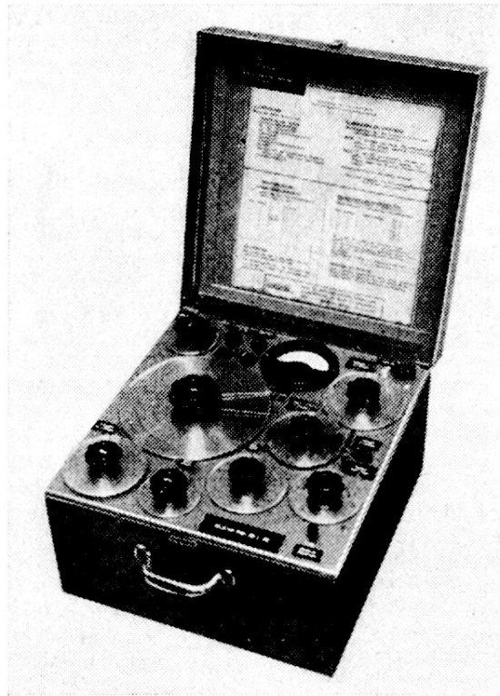
Figur 8. Rechengerät zur Ermittlung der atmosphärischen Störungen einer Geschöß-Flugbahn
