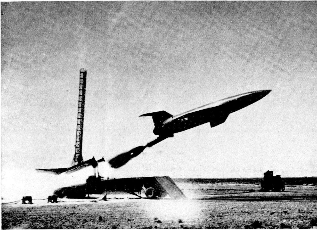
Le «Matador» quittant sa rampe de lancement sous l'impulsion de sa seule fusée de démarrage; le mât métallique à l'arrière est sans doute destiné à hisser l'engin sur la rampe. Photo OTAN
