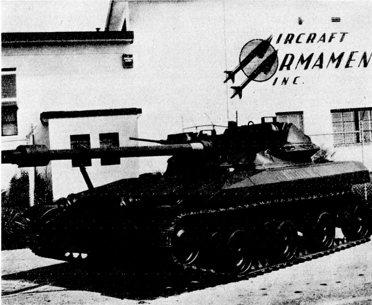
Bild 2: Leichter Panzerwagen von 18 Tonnen («T96») mit Kanone 76 mm, vorgesehen für die amerikanische Luftlandedivision.
