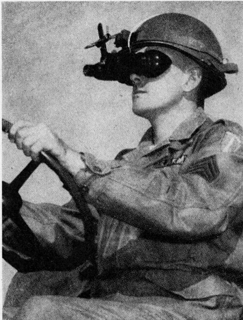
Fig. 3. Dieser Feldstecher wurde für Fahrzeugführer und taktische Führer geschaffen, die mit diesem Gerät ein mit Infrarotlicht überdecktes Gelände überwachen können bzw. ungefähr die Tagesfahrgeschwindigkeit einhalten können.
