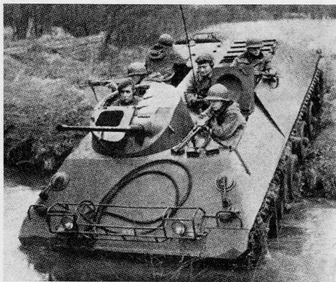
Bild 3. Der Schützenpanzer HS-30 der deutschen Armee. Die Lücken im Dach sind gleichzeitig Ausstiegsöffnungen für die Besatzung an Stelle der Hecktüre
