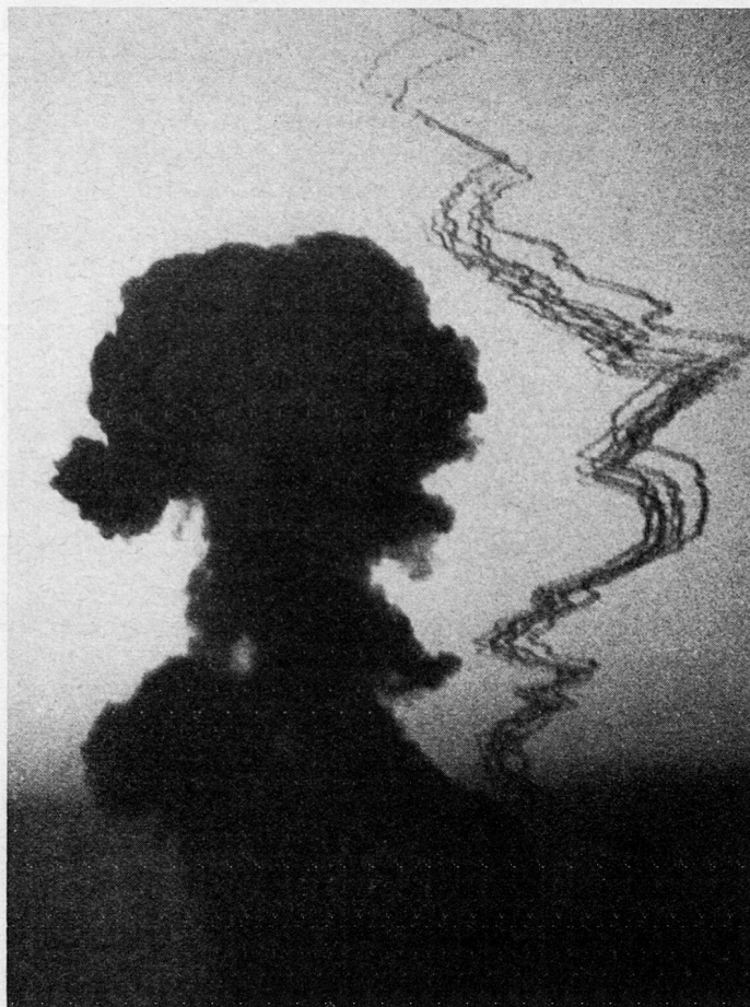
Reggane, 3e explosion. Formation du champignon avec stries fumigènes pour l'étude de la propagation de l'onde de choc
