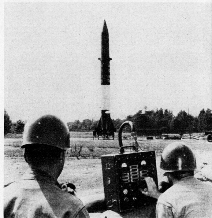
«Redstone» abschußbereit. Im Vordergrund der Schießoffizier mit dem Kommandogerät für die Auslösung des Startes
