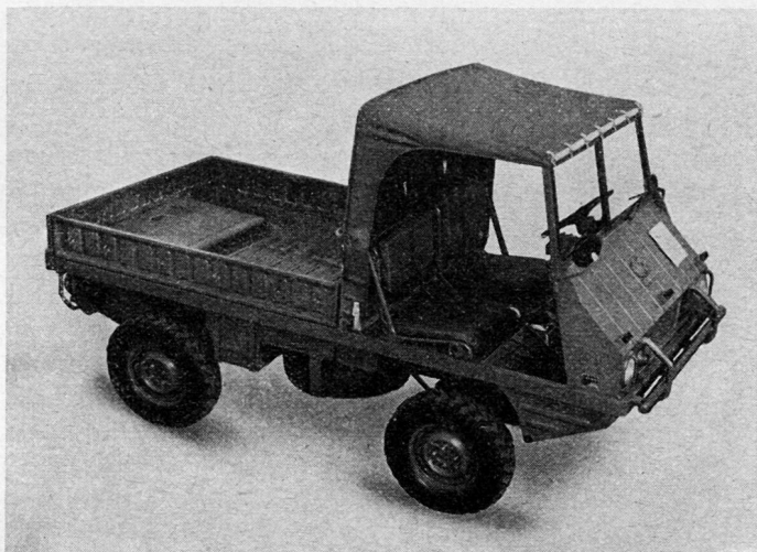
Klein-Geländelastwagen Haflinger von Steyr-Daimler-Puch Typ 700 AP als Brückenlastwagen mit Verdeck
