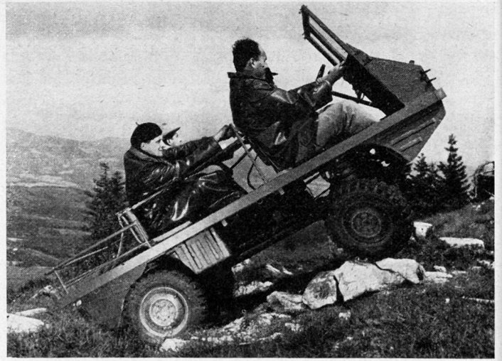
Geländelastwagen Haflinger bei Steigversuchen im Gelände. Für den Einsatz in der Armee dürfen keine Personen auf der Ladebrücke transportiert werden
