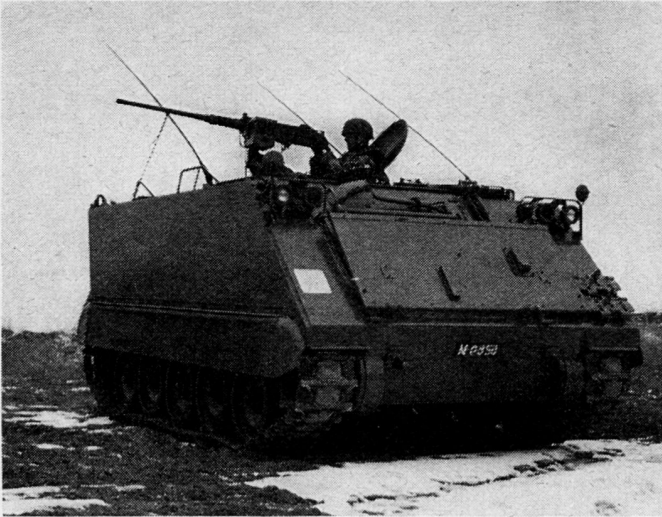
Bild 1. Die Bewaffnung des M113 besteht aus einem überschweren Maschinengewehr 12,7 mm mit einer Kadenz von 400 bis 500 Schuß pro Minute und einer praktischen Schußweite von 1800 m. Die Bedienung erfolgt durch einen Mann.
