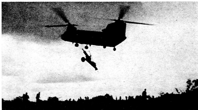
Bild 2. Boeing-Vertol CH-47 beim Transportieren einer 10,5-cm-Haubitze.
