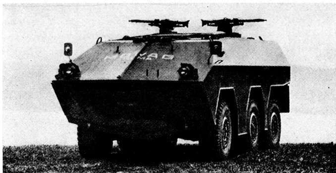
Bild 6. Die Firma Mowag hat ein schwimmfähiges gepanzertes Radfahrzeug entwickelt, das als Schützenpanzer oder Waffenträger verwendet werden kann. Die abgebildete Version zeigt den «Puma» als Schützenpanzer mit zwei Maschinengewehren auf Scheitellafetten.
