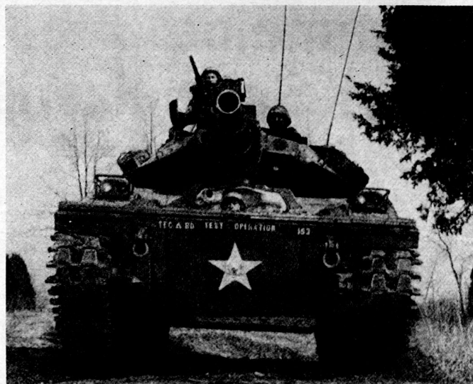
Bild 1. Der amerikanische Aufklärungspanzer «General Sheridan» mit dem neuen Waffensystem «Shillelagh», das in Zukunft auch auf Kampfpanzern Verwendung finden dürfte.
